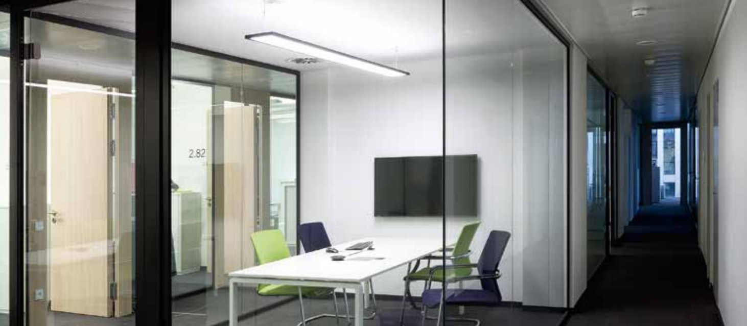
Abb.: Die Pendelleuchte »LED Around« hängt in Konferenz- und Besprechungsräumen. Im ausgeschalteten Zustand erscheint der Leuchtkörper transparent. Eingeschaltet erzeugt sie ein homogenes Licht mit 40 Prozent Indirektanteil.
